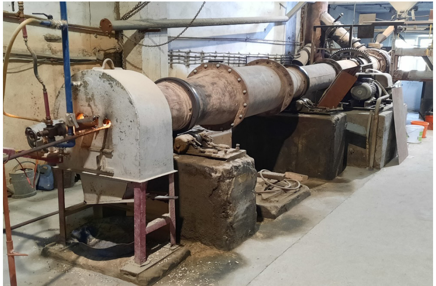
Rys. 2. Piec obrotowy w skali półtechnicznej; wymiary: \Phi 0,38 m x 7m; zakres temperatur 800 - 1450°C; wydajność 50 kg/h; prędkość obrotowa pieca: 0.5-4.0 rpm, paliwo: olej opałowy.
