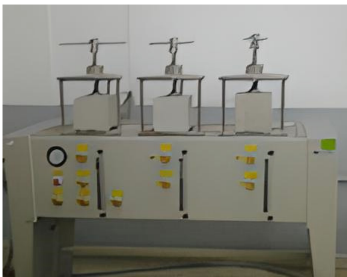
Rys. 10. Badanie przepuszczalności wody.
