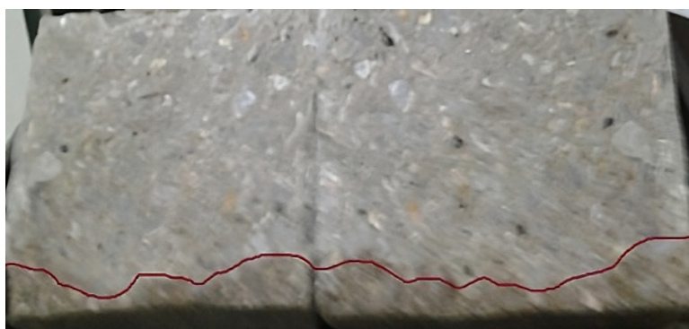
Rys. 11. Schematyczne przedstawienie wysokości penetracji wody w próbce przeciętej na dwie części - czerwona linia.
