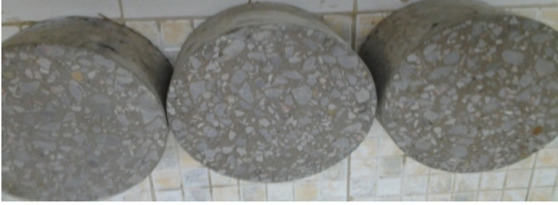
Rys. 8. Ocena wizualna dystrybucji kruszyw w próbce C1.6-10.
