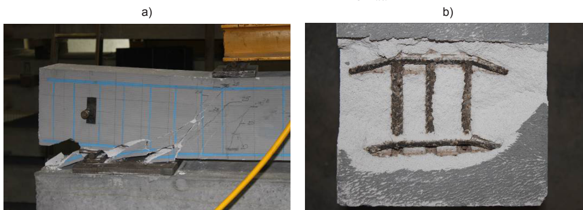
Rys. 13. Widok elementu serii C w chwili zniszczenia: a) strefa przypodporowa, b) deformacje ramion strzemion w strefie przypodporowej
