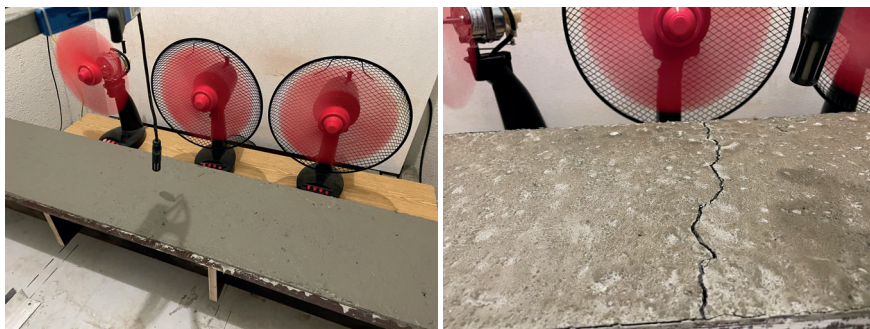
Rys. 1. Badanie skurczu plastycznego betonu
