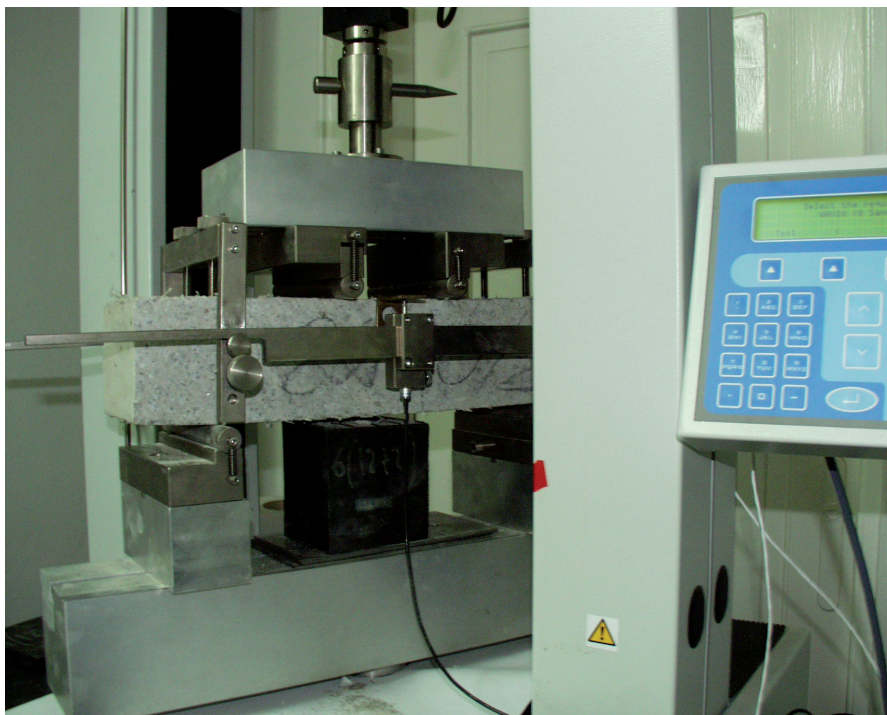
Rys. 1. Próbkę fibrobetonową podczas badania na zginanie oraz sposób zamocowania mierników ugięcia i pomiaru względem osi obojętnej belki po obu stronach
