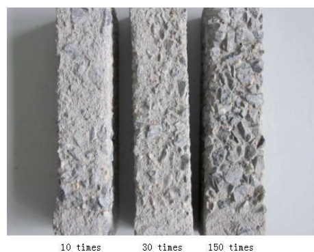
Rys. 1. Powierzchnia próbek betonu po 10, 30 i 150 cyklach zamrażania i rozmrażania
