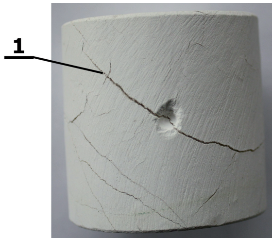
Rys. 5. Próbkę wapienia po kalcynacji: 1 – pęknięcia skurczowe (17)
