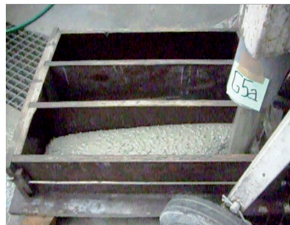
Rys. 2. Badania rozplywu mieszanek samozagęszczalnych z włóknami stalowymi oraz formowanie belek o wymiarach 600x150x150 mm
