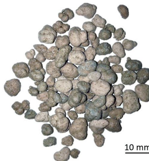
Rys. 1. Lekkie kruszywo ceramiczne [LWA], frakcja 4 - 8 mm
