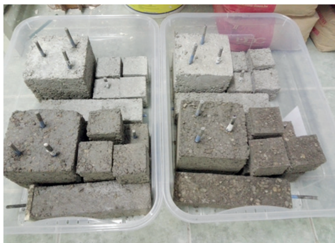
Rys. 2. Próbki po wyjęciu z form, w których dojrzewały 24 godziny
