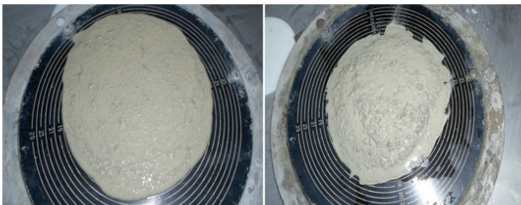
Rys. 4. Płynność badana za pomocą mini-stożka; [a] SZZ – 50%, [b] SZZ – 100%
