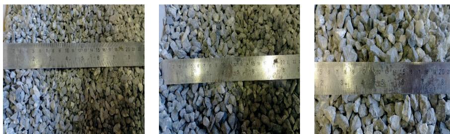
Rys. 1. Kruszywo z rozdrobnionego BW o różnych wymiarach: (a) 4-8 mm, (b) 8-12,5 mm, (c) 12,5-16 mm
