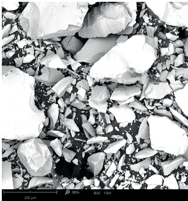
Rys. 3. Ziarna szkła kineskopowego, po zmieleniu pod mikroskopem, powiększenie 380x
